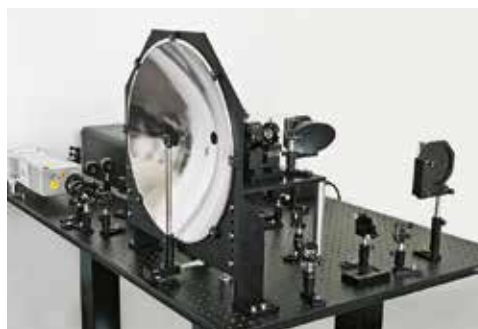
Рис. 3. Терагерцовый спектрометр T-SPEC, интегрированный в ЛИДАР, работающий в ТГц области спектра, использующийся для дистанционного сканирования образцов на расстоянии в 7 метров. ТГц ЛИДАР, установленный в МГУ им. Ломоносова, Россия
