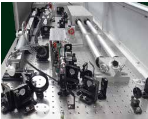
Система усиления: 1 Дж, 1060 нм, 800 пс, спектральная ширина линии усиления \approx 4 нм
